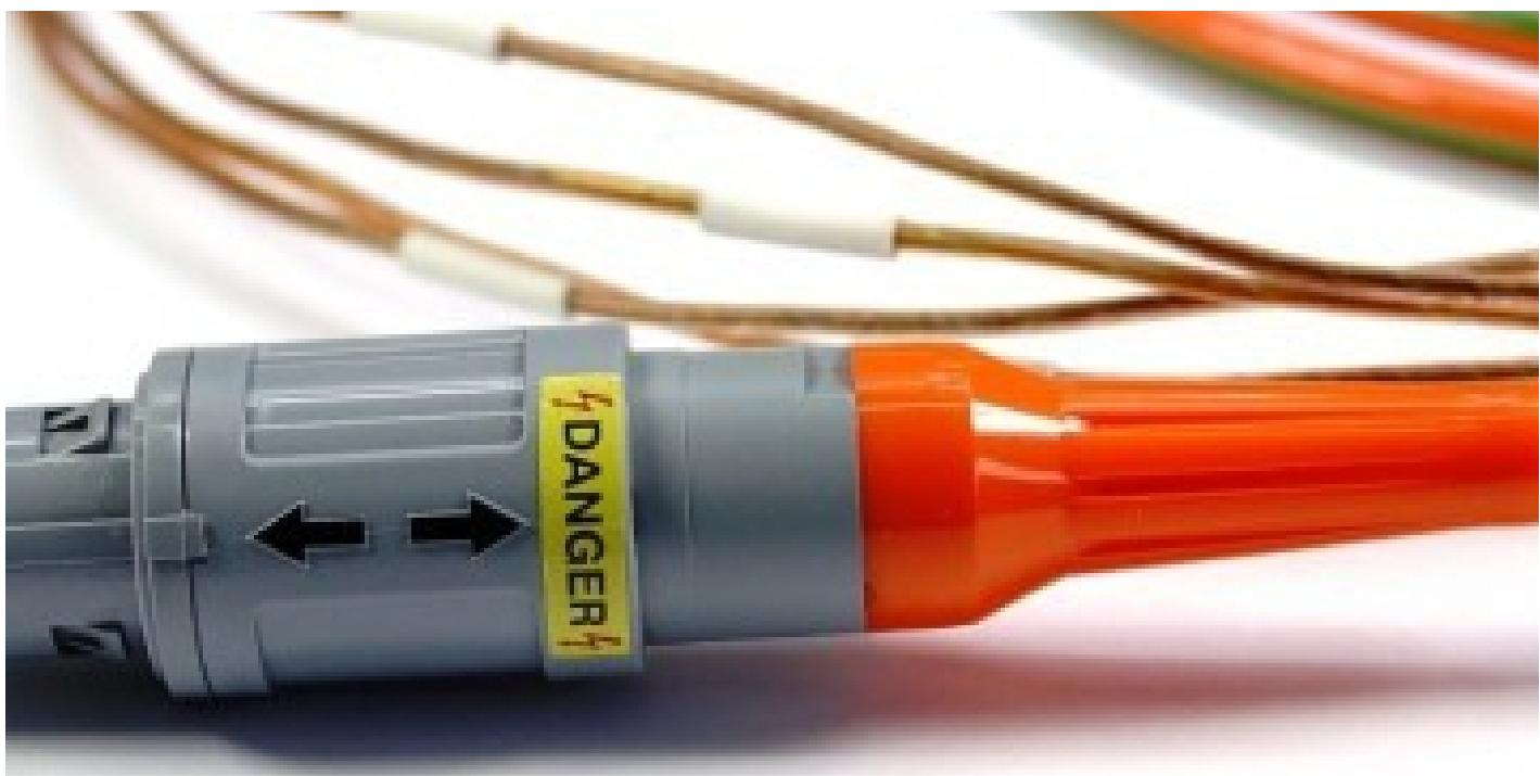
跃思2014年开发的这款高压电缆接触性良好且坚固耐用。由PUR材料制成的橙色外护套明确识别该电缆为车辆电网中高压范围的应用产品。凭借其小直径，这款电缆尤其符合对节省空间要求高的应用。由于高压电缆经常位于在车身的某些摩擦点上，因此高压电缆的结构还包含一层蓝色中间护套。如果蓝色中间护套变得可见，则表明电缆保护套已不再可靠。
